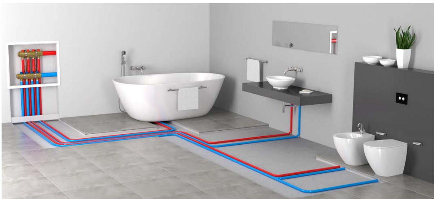
Водопроводна система изпълнена с многослойна тръба, изолирана или с цветно защитно гофре
